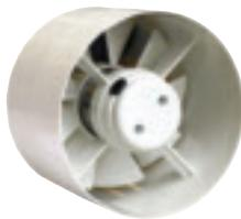
Линейные осевые вентиляторы IF предназначены для вытяжки из ванных комнат, санузлов и душевых, часто используются совместно с вентиляторами BF для преодоления сопротивления разветвленной системы воздуховодов.. Изготовлены из ударопрочного пластика ABS. Вентиляторы IF оборудованы однофазными индукционными двигателями с предварительно смазанными подшипниками..
