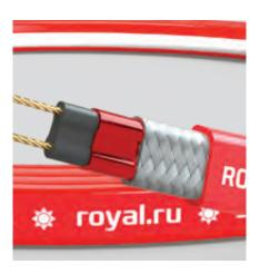
Все нагреватели производятся из саморегулирующегося греющего кабеля с оплеткой из луженой меди и двойной полимерной оболочкой. Функция саморегулирования дает возможность перехлестывать кабель, не образуя зон перегрева
