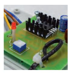
Регуляторы не только управляют скоростью вращения вентилятора, но и имеют функцию стартового обдува, а также индикацию режимов работы и результатов самодиагностики, что значительно упрощает установку и контроль работоспособности
