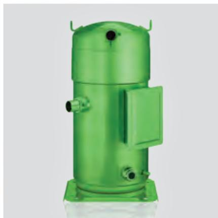
В каждом контуре охлаждения установлены надежные и эффективные спиральные компрессоры BITZER со специальной системой маслоотделения, обеспечивающей минимальный унос масла в систему – не более 0,2 % [для моделей от 34,5 кВт].
