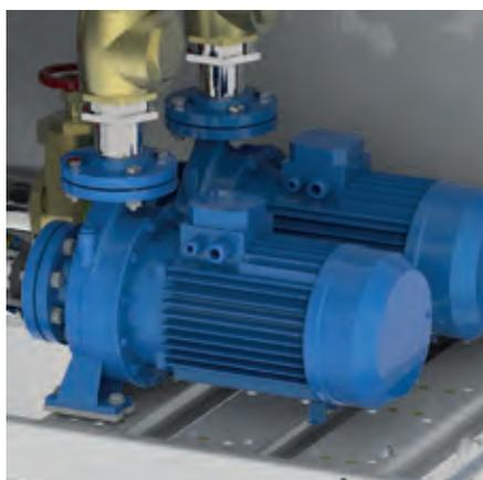
Сдвоенные центробежные насосы работают по схеме «один рабочий + один резервный». Каждый насос оснащен одним рабочим колесом, корпусом из чугуна, электродвигателем в алюминиевом оребренном корпусе с уплотнением из керамики/графита/EPDM (IP55) и с валом двигателя из нержавеющей стали AISI 304.
