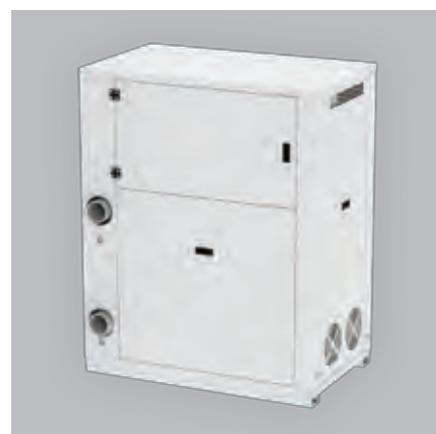
Корпус изготовлен из оцинкованной углеродистой стали и оцинкованных панелей с порошковым покрытием, что защищает агрегат от коррозии и негативного воздействия окружающей среды. Панели легко снимаются, обеспечивая удобство доступа к внутренним компонентам. Трубопроводы и компоненты покрыты теплоизоляцией из неопренового пенопласта толщиной 9 мм.
