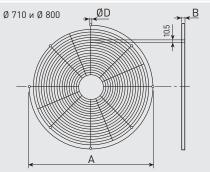
Размер ячейки решетки: 10,6 х 10,6 (модели от 250 до 630). Размеры (мм).
