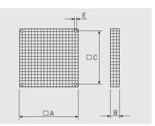
Размер ячейки решетки: 10,6 x 10,6 (модели от 250 до 525). 25 x 25 (модели от 630 до 1000). Размеры (мм).
